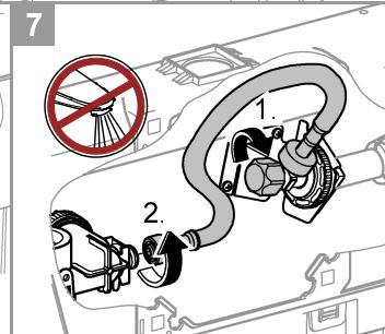
Skyddsör med YD 25mm ska användas tillsammans med medlevererad genomföring/tätnings. Mediaröret ansluts mot R15 (1/2") utvändig gänga med koppling enligt mediarörets monteringsanvisning. CE godkända medierör i Ø12/Ø16mm med skyddsör YD 25mm kan användas. Dimension tillkoppling avstångnings-ventil: R15 (1/2") utvändig rörgänga. Täthetskontroll av röranslutningarna ska utföras efter installationen.
